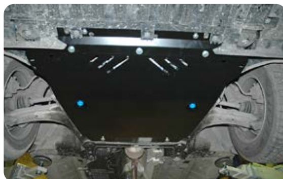
MÉGANE - BLOK MOTORU + PŘEVODOVKY
